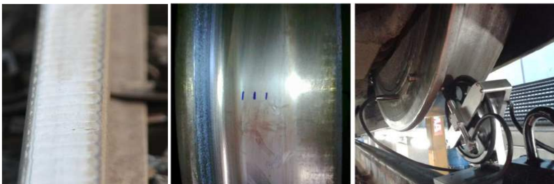
figuur 7 Golfslijtage, wiel met beperkte ruwheid en middelmatige ruwheid (wielruwheidsmetingen met m|wheel )
